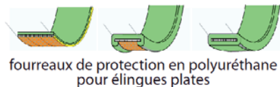
fourreaux pour sangles de levage et élingues tubulaires
